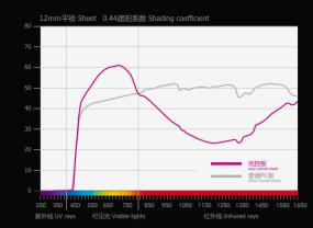
上图所示,光控板材对可见光的透过率明显高于普通板材,而对红外线的透过率,却远远低 于没有此功能的板材。在光照的高峰时段,采用光控板材的环境室内温度,比起普通板材, 至多可以低 10℃ 的温差,环境改善功能非常明显!
