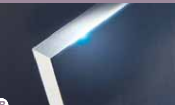
B 采用强光手电对板材横截面进行照射，板材的UV层会显得明亮许多，仿佛板材表面镶了一道银边，且能清晰的看出UV分布是否均匀。
