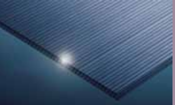
A 板材表面没有共挤UV，经照射着不出有明暗的特征。 No UV layer, no silver line under UV flashlight.
