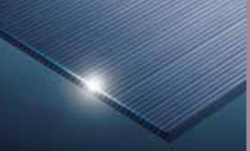
B 采用强光手电对板材横截面进行照射，与板材其它部分相比，UV层会变得明亮许多，仿佛板材表面镀了一道银边，且能清晰的看出UV分布是否均匀。
