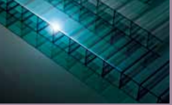
B 采用强光手电对板材横截面进行照射，与板材其它部分相比，UV层会变得更亮许多，仿佛板材表面镀了一道银边，且能清晰的看出UV分布是否均匀。
